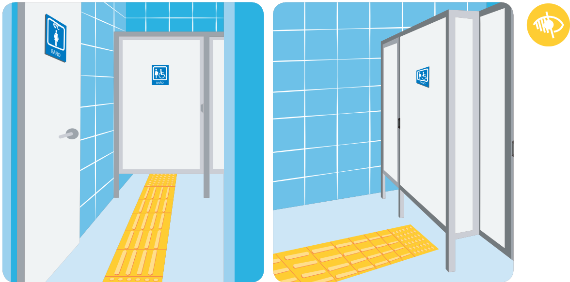
Figura 55: Señalización podotáctil en los servicios higiénicos.
